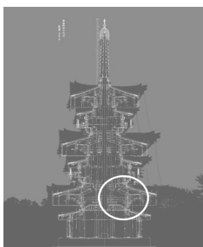
写真4 薬師寺三重塔 (○の部分が初重斗組み)
