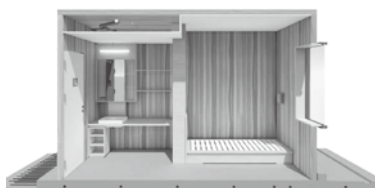
(図2) ユニットの構成壁はスギ、造作家具は広葉樹で、木質感溢れる空間となっている
